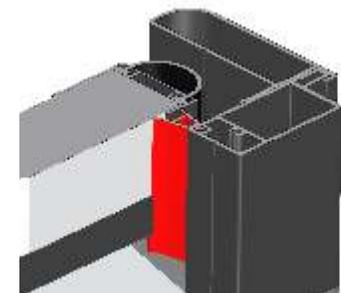
Joint tubulaire à lèvre EPDM côté fermeture
