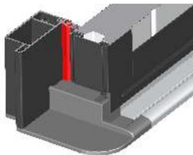
Joint d'étanchéité tubulaire EPDM côté ouverture
